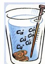
Les ions cuivre dans la solution sont attirés par le clou d'acier car celui-ci a une charge négative. Au contact du clou, ces ions se collent à l'acier, ce qui lui donne **un aspect cuivré**.
